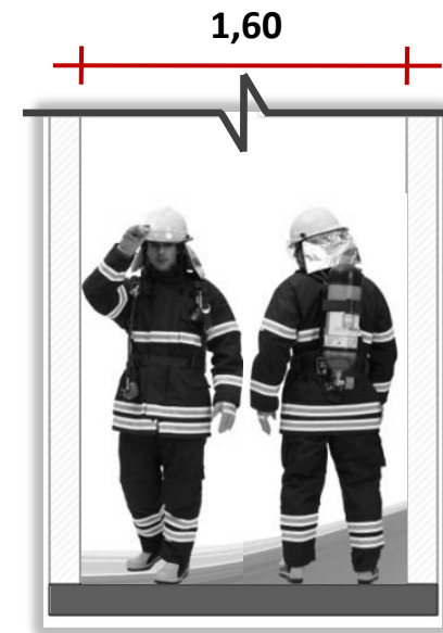
Fig. 54 – Corte esquemático de corredores com 1,60 m de largura, origem da dimensão para modulação da malha. Sem Escala. Fonte: o autor.
